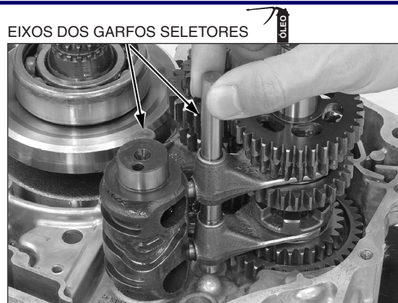
EIXOS DOS GARFOS SELETORES
