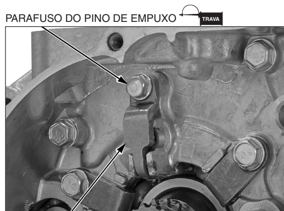
PARAFUSO DO PINO DE EMPUXO PLACA DO PINO DE EMPUXO TENSOR DA CORRENTE DE COMANDO PLACA DE FIXAÇÃO
